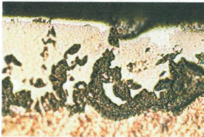
Camada de aço 1020 carbonitretado e boretado a 950°C, 4h (100x)
